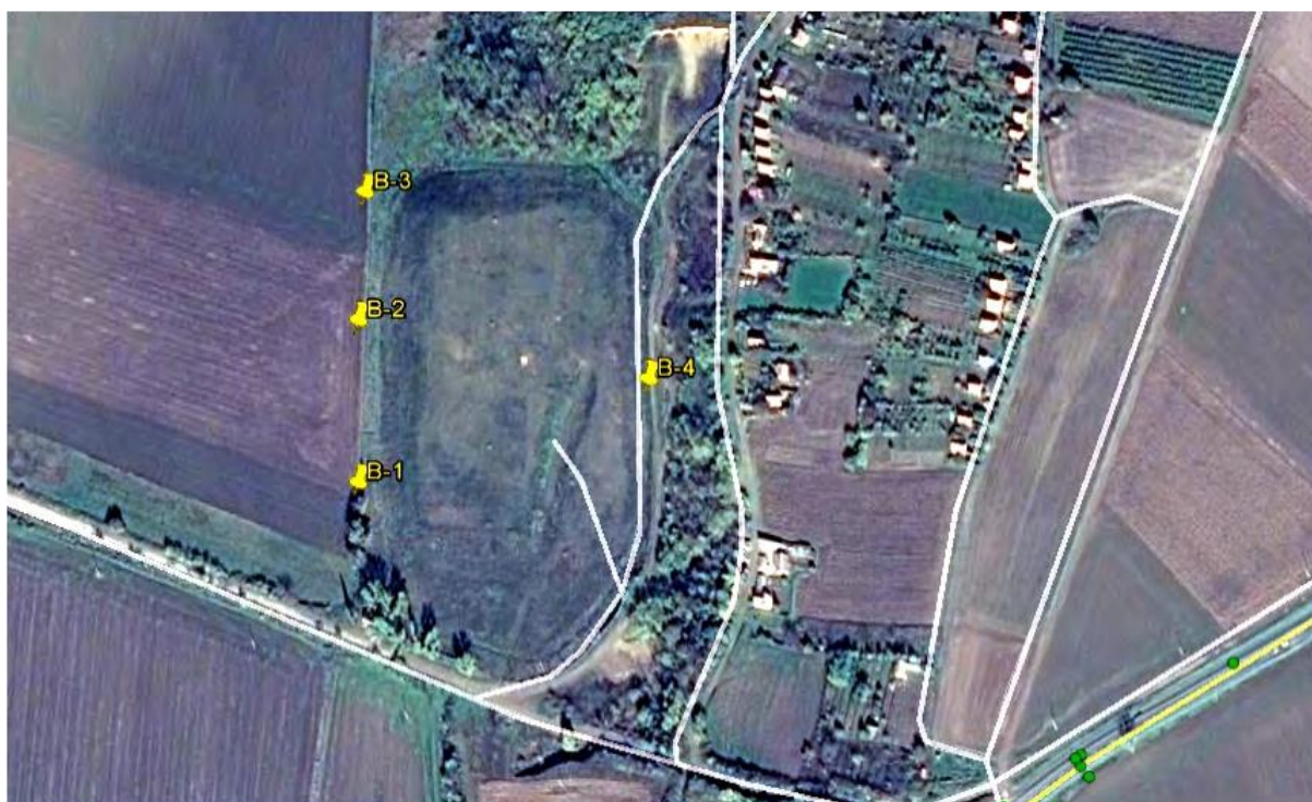
21.számú ábra Monitoring kutak helyzete a rekultivált hulladéklerakón
